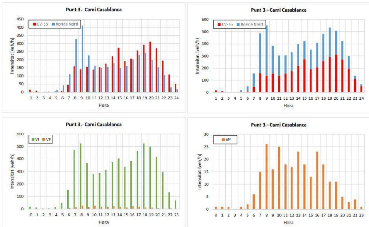
Figura 1.14. Aforos automáticos en la carretera Casablanca. Fuente: PMUS Poble de Vallbona.
